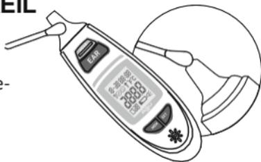
Lentille / capteur de mesure:
